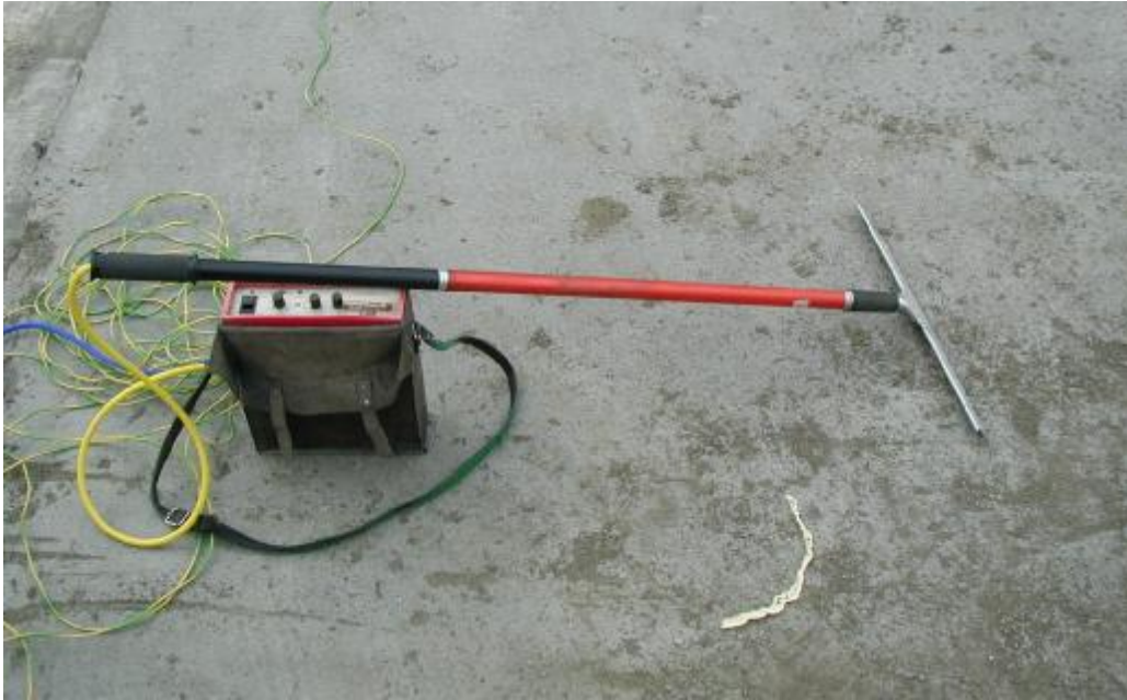
Foto 4. Poroskop - přístroj pro provádění jiskrové zkoušky.
