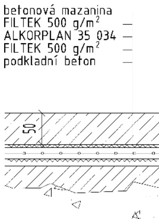
Schéma 6 - Ochrana vodorovné hydroizolace
